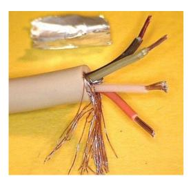
Falls dem Programmer kein USB-Kabel mit offenem Ende, sondern ein USB-Verlängerungskabel beiliegt, schneiden Sie bitte das Ende mit der USB-Kupplung mit einem Seitenschneider ab.
