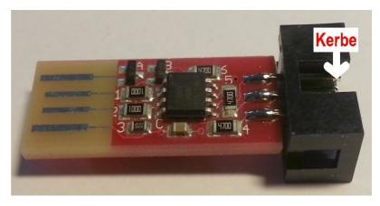
des Steckers befinden sich auf der Platinenunterseite. Achten Sie unbedingt darauf, dass sich die Kerbe des Wannensteckers ebenfalls oben befindet. Der Wannenstecker ist etwas breiter als die Platine. Richten Sie ihn mittig aus, so dass er auf seinen beiden Seiten gleich weit über den Platinenrand herausragt. Die Stifte des Wannensteckers dürfen kein Platinenbauteil berühren.
