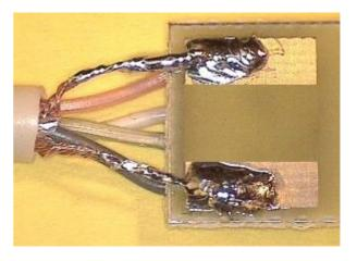
Zum Abschluss der Arbeiten müssen Sie den Schrumpfschlauch über die Platine schieben. Er lässt sich mit etwas Heißluft fixieren. Am besten warten Sie mit dem Fixieren aber noch, bis der Programmer seine ersten Tests bestanden hat.
