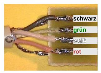
Für den Fall, dass das USB-Kabel ein Geflecht besitzt, löten Sie dieses an die beiden nicht verbundenen Leiterbahnen auf der Unterseite der Platine (siehe Abbildung rechts unten).
