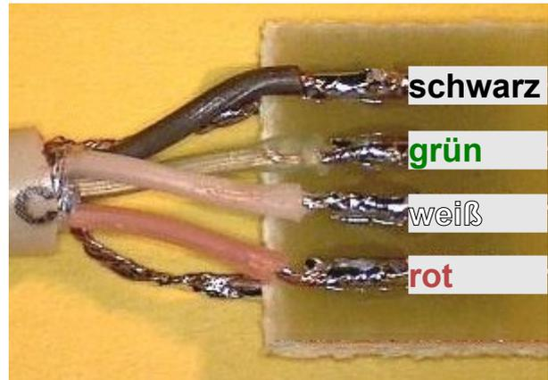
Für den Fall, dass das USB-Kabel ein Geflecht besitzt, löten Sie dieses an die beiden nicht verbundenen Leiterbahnen auf der Unterseite der Platine (siehe Abbildung rechts unten).
