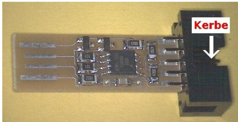
Löten Sie nun alle 10 Kontakte des Wannensteckers an der Platine fest, 5 auf der Platinenoberseite und 5 auf der Platinenunterseite.
