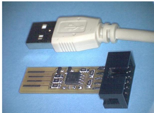
Zum Anschluss des jeweiligen Mikrocontrollertyps benötigen Sie noch einen entsprechenden Adapter bzw. ein Adapterkabel mit 10-poligem Stecker. Zahlreiche Bauanleitungen dazu finden Sie über die am Ende dieser Anleitung aufgeführten Web-Empfehlungen. Oder Sie entscheiden sich für den Universal-Adapter *guloboard G10*, welchen Sie ebenfalls in unserem Shop finden.
